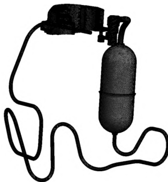
图 1 冰箱压缩机排气流域模型网格
